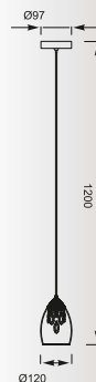
SOFIA Pendant MD1501-1 1*G9 MAX 42W transparent glass / crystal inside / metal chrome
